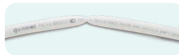
Излом трубы Gummel PE-Xa и ее восстановление после нагрева до 100 °С.
